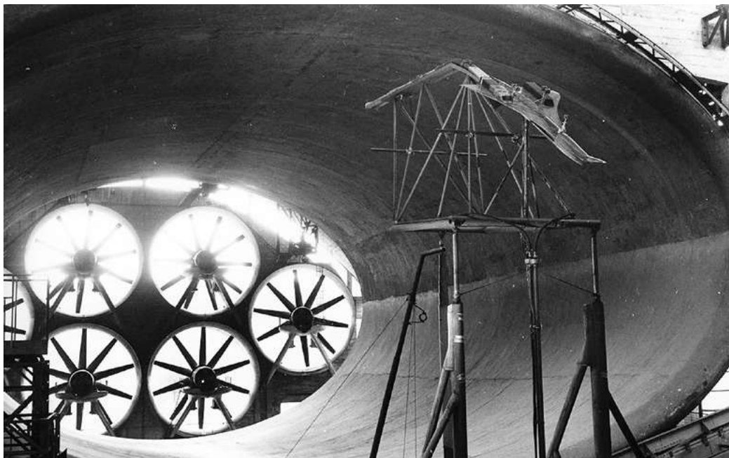
Étude sur une maquette des différents cas de vol et recherche sur les ailes élançées dans une soufflerie de Modane
